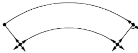
Abbildung 6.3: Prinziplagerung einer gekrümmten, einfeldrigen Brücke [7]
