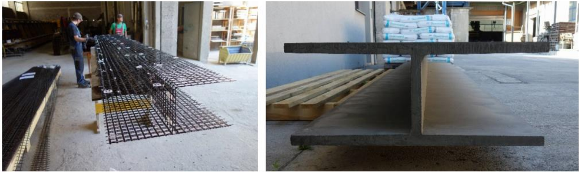
Abb. 20: CFRP – Bewehrungskorb (links); ausgeschaltetes Einzelement (rechts) [Kromoser 2017][S.11]
