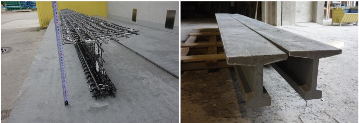
Abb. 11: Bewehrungskorb (links); Konfiguration 1 und 2 (rechts) [Kromoser 2017][S.14]
