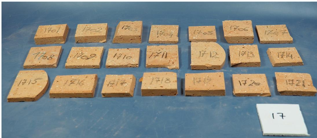
Abb. D.1: HLz 17 mit Bohrkernen und daraus gewonnen Scherben
