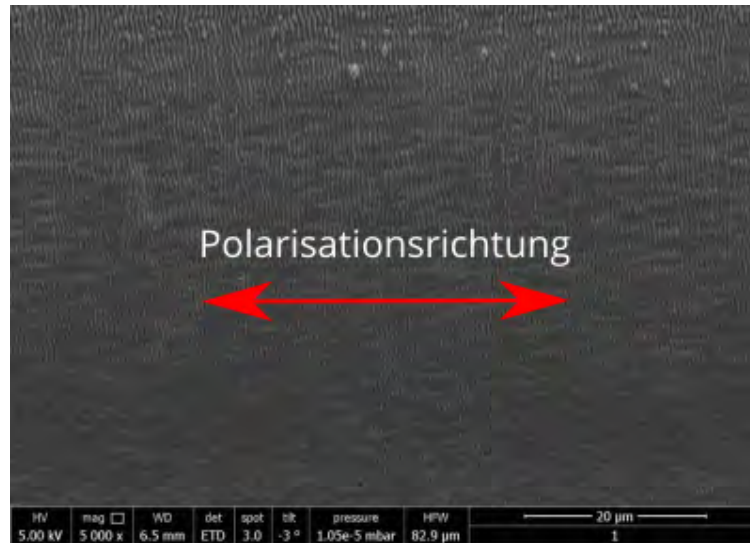
Abbildung 2.1.: Orthogonal auf die Polarisations Ebene der Laserstrahlung stehende Orientierung der LSFL
