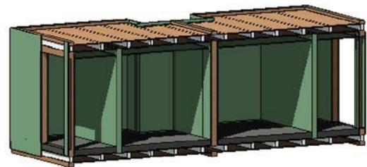
Abb. 128: 3-D Nasszellen Leicht
