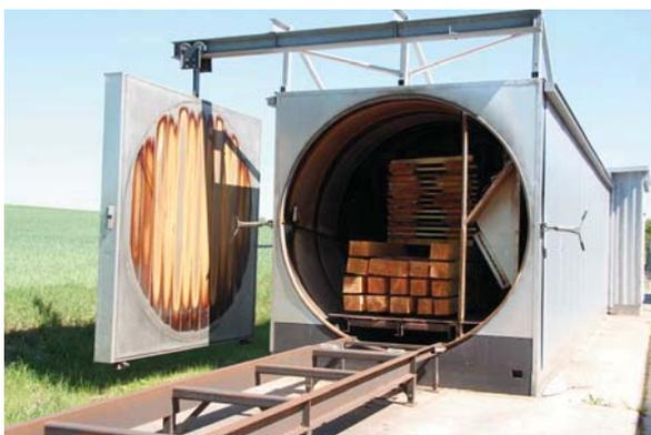
Abb. 211: Foto Vakuum- und Umlufttrocknungsanlage, Longin
