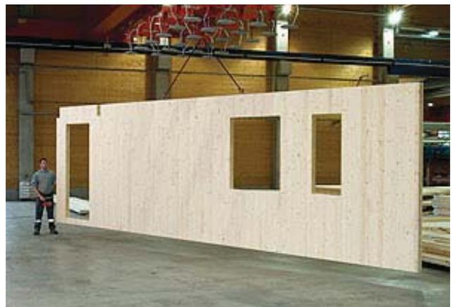
Abb. 45: Foto Brettsperrholzplatte Produktion
