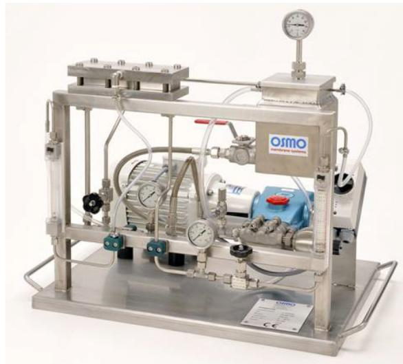
Abbildung 6: Testzellenanlage für Vorversuche im Labormaßstab aus dem von der Emde-Technikum der TU Wien (OSMO, 2012)
