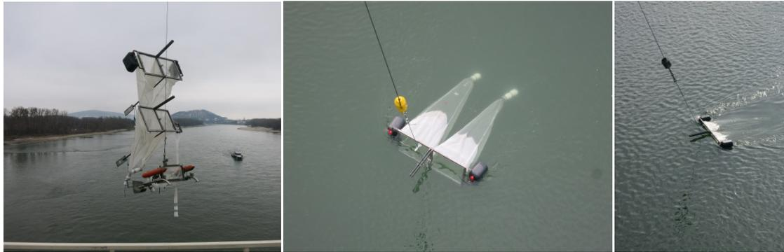
Abbildung 1: Darstellung der Beprobungapparatur mit Einlaufrahmen in drei Horizonten (li), Manta-Netze (mi) und die abgetauchte Apparatur mit dem obersten Horizont (re). © IWHW/BOKU
