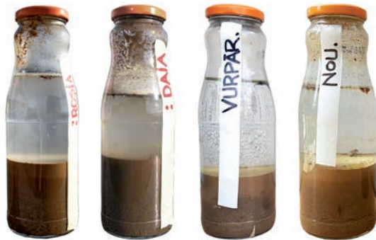
Abb. / Fig. 28 Lehmtests Testarea probelor de pământ Roşia, Febr. 2015
