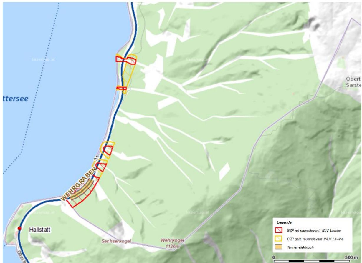
Abbildung 17: Visualisierung von Lawineneinzugsgebieten entlang der Salzammergutbahn
