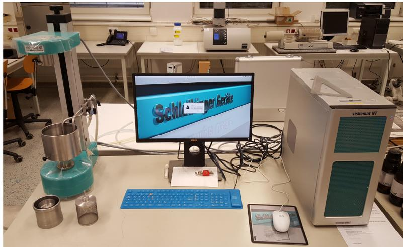
**Abbildung 3.6:** Rotationsrheometer Viskomat NT mit Steuerungseinheit
