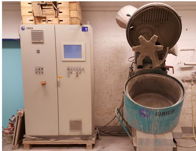
**Abbildung 3.3:** Eirich-Intensivmischer R08W und dessen Steuereinheit
