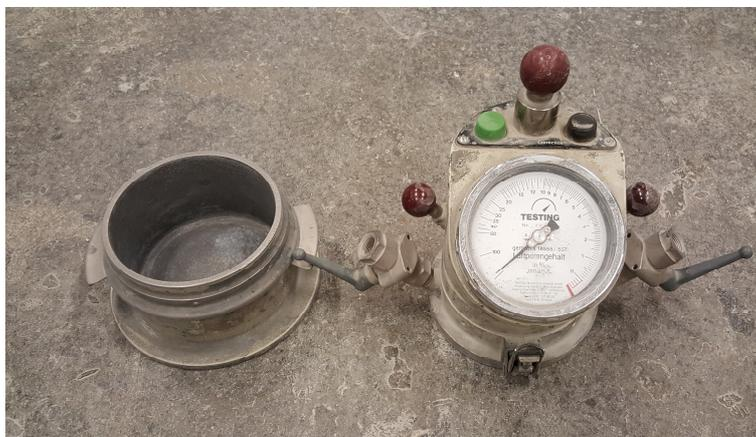
**Abbildung 3.16:** Luftporentopf zur Bestimmung des Luftgehalts des Frischbetons
