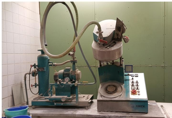
**Abbildung 3.4:** Eirich-Intensivmischer R02 (rechts) mit Vakuumanlage (links)
