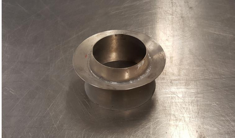
**Abbildung 3.14:** Setztrichter zur Bestimmung des Ausbreitfließmaßes
