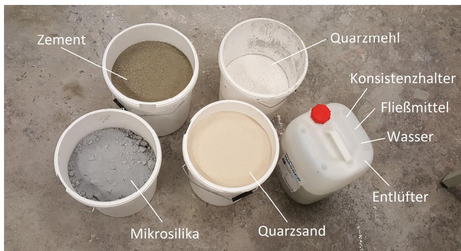
**Abbildung 3.2:** Bestandteile für eine Betonmischung von 40 dm<sup>3</sup>
