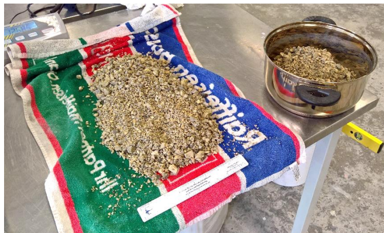
Abb. 19: Abtrocknung der Gesteinskörnung mittels Tuch [Autor]
