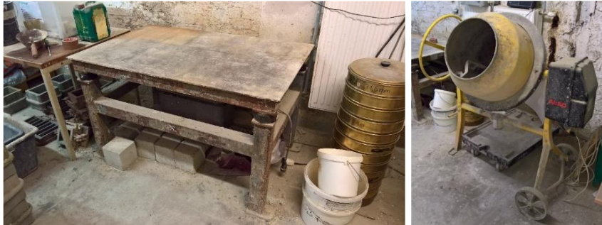
Abb. 26: links: Rütteltisch und rechts: Betonmischer [Autor]
