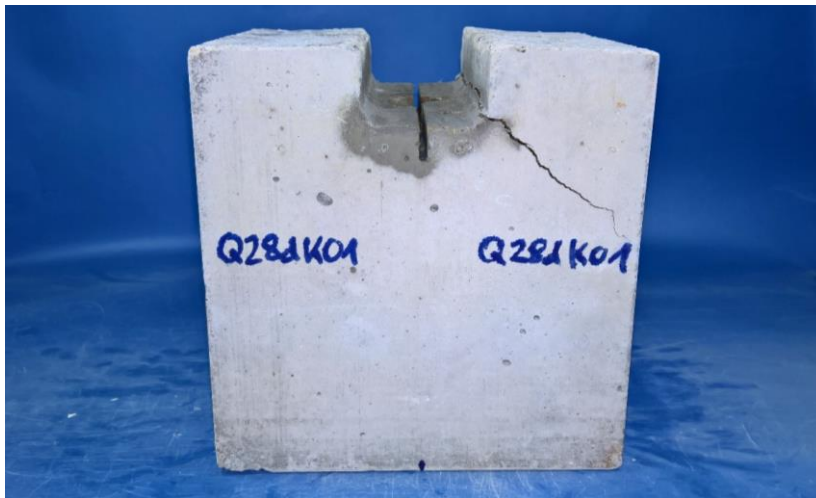
Abb. 79: Unzulässiger Rissverlauf bei der Probe Q28dK01 (Starterkerbe mit 10% der Ligamenthöhe) [Autor]
