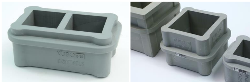
Abb. 24: Formen (links: Würfel 100 mm [4] und rechts: Würfel 150 mm [5])
