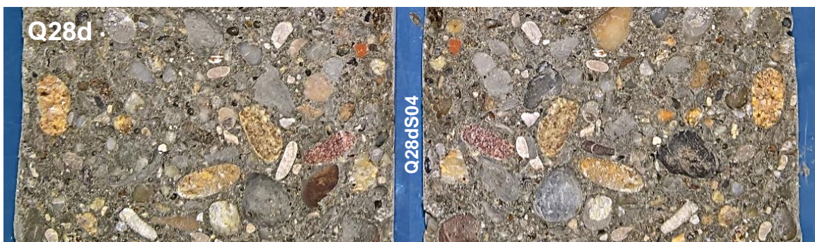
Abb. 59: Bruchflächen Spaltzugversuch – Beton mit Quarzkies und einem Probenalter von 28 Tagen [Autor]
