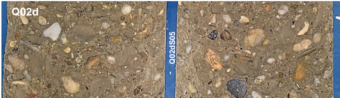
Abb. 57: Bruchflächen Spaltzugversuch – Beton mit Quarzkies und einem Probenalter von 2 Tagen [Autor]
