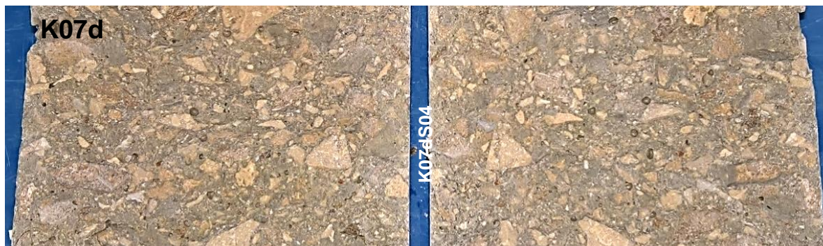
Abb. 61: Bruchflächen Spaltzugversuch – Beton mit Kalkstein und einem Probenalter von 7 Tagen [Autor]
