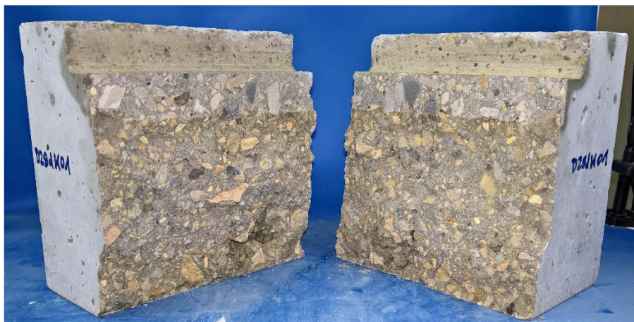
Abb. 84: Bruchflächenansicht beim Beton mit Dolomit- D28dK01 [Autor]
