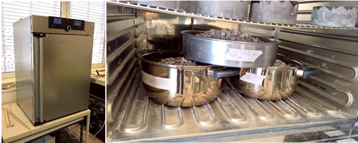
Abb. 20: Messproben im Trockenschrank bei 105°C [Autor]
