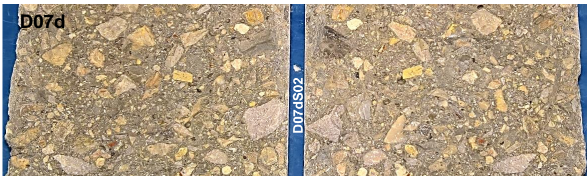
Abb. 64: Bruchflächen Spaltzugversuch – Beton mit Dolomit und einem Probenalter von 7 Tagen [Autor]
