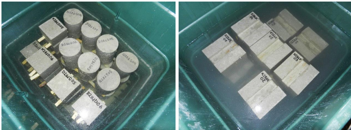
Abb. 34: Wasserlagerung der Probekörper, Links: Druck- und Spaltzugversuch, Rechts: Keilspalt- und E-Modulversuch [Autor]
