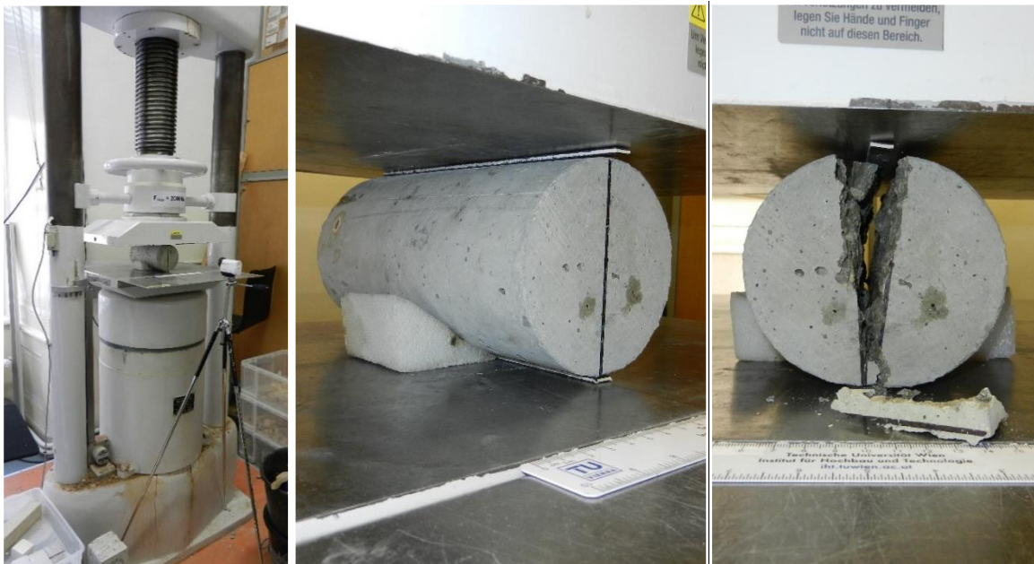
Abb. 54: Spaltzugversuch (v. l. n. r.: Prüfmaschine, Versuchskörper vorher u. nachher) [Autor]
