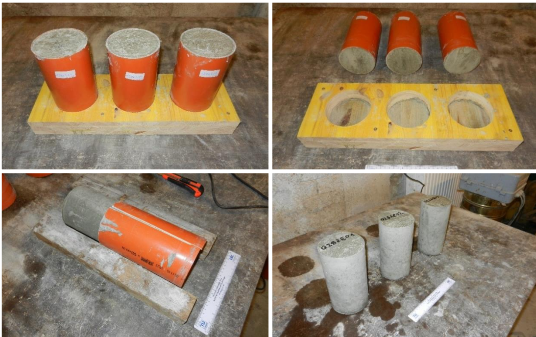
Abb. 31: Lösen der Probekörper aus den Formen [Autor]
