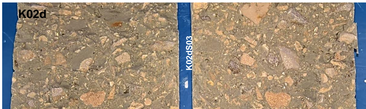
Abb. 60: Bruchflächen Spaltzugversuch – Beton mit Kalkstein und einem Probenalter von 2 Tagen [Autor]
