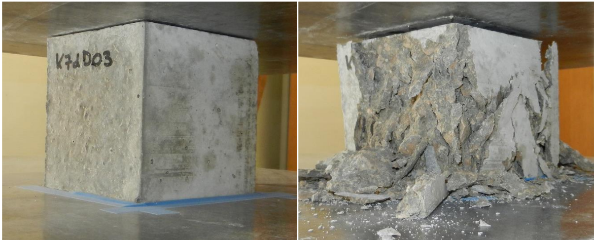
Abb. 46: Probe während der Versuchsdurchführung (links: vorher, rechts: nachher) [Autor]
