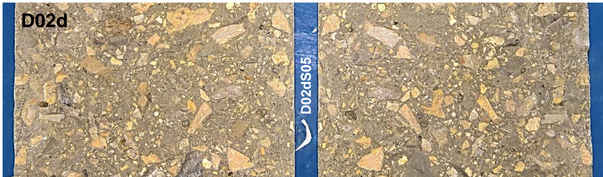
Abb. 63: Bruchflächen Spaltzugversuch – Beton mit Dolomit und einem Probenalter von 2 Tagen [Autor]
