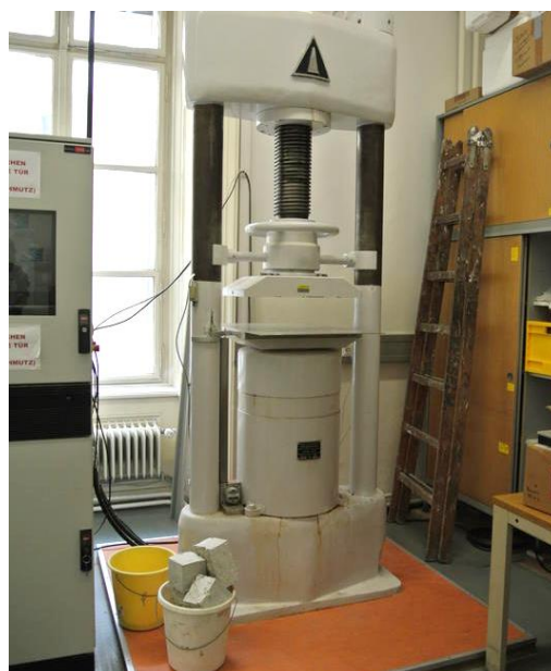
Abb. 44: Hydraulische Druck-Prüfmaschine der Firma Seger 2000 kN [Autor]
