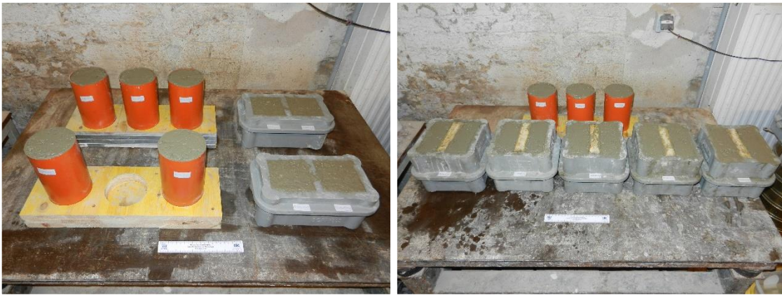
Abb. 30: Verdichtete Prüfkörper, Links: Druck- und Spaltversuchskörper, Rechts: Keilspalt- und E-Modulversuchskörper [Autor]
