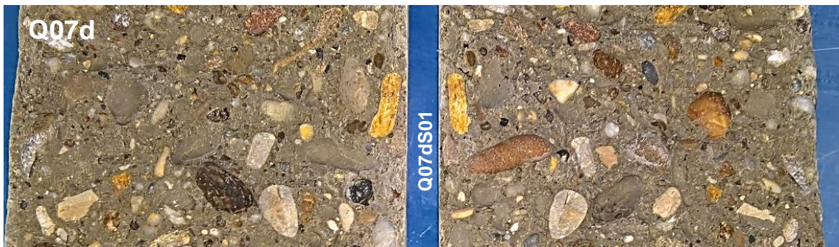
Abb. 58: Bruchflächen Spaltzugversuch – Beton mit Quarzkies und einem Probenalter von 7 Tagen [Autor]
