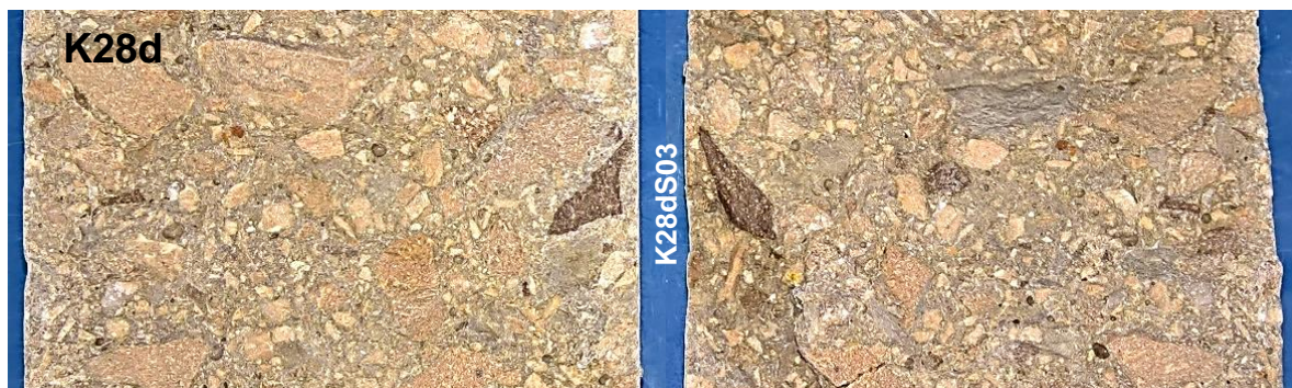
Abb. 62: Bruchflächen Spaltzugversuch – Beton mit Kalkstein und einem Probenalter von 28 Tagen [Autor]
