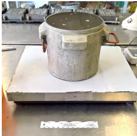
Abb. 18: Luftporentopf + GeK wassergesättigt + Auffüllwasser [Autor]
