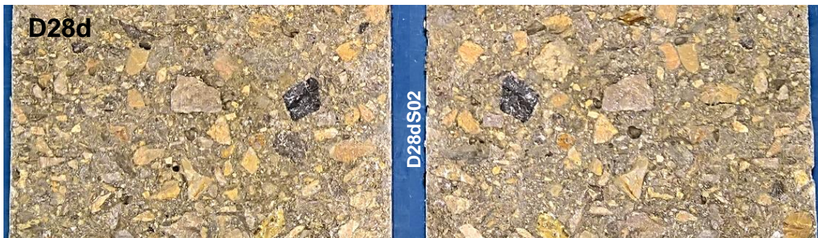
Abb. 65: Bruchflächen Spaltzugversuch – Beton mit Dolomit und einem Probenalter von 28 Tagen [Autor]
