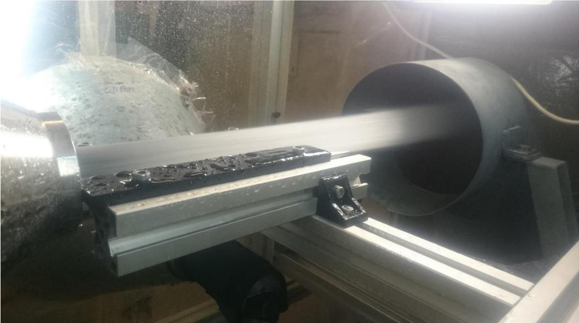
Abbildung 31: Wasserstrahl der Pelton-Düse während der Vermessung
