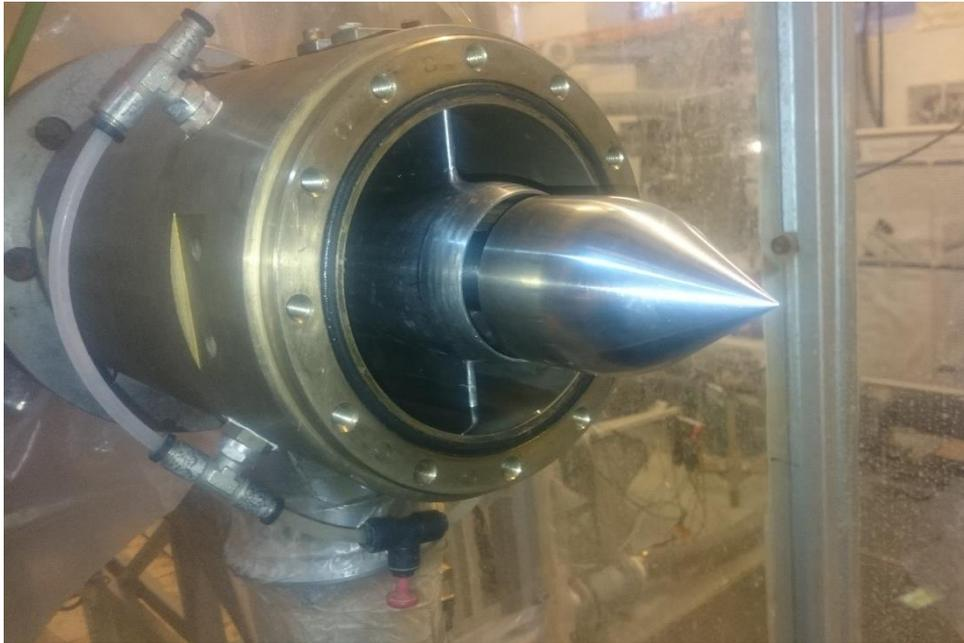
Abbildung 11: Geöffnete Pelton-Düse
