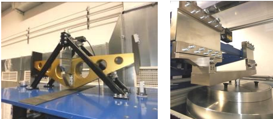
Abbildung 36: Konstruktion der Balkenwaage mit Festkörperlager 2 kN-Totlastkraftanlage und 250 kN-Totlastkraftanlage
