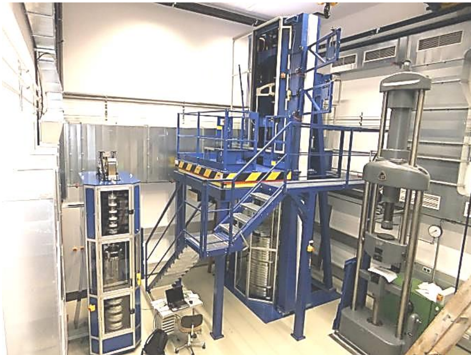
Abbildung 33: Realisierung der Totlastkraftanlagen 2 kN und 250 kN mit der verbundenen hydraulischen 1MN-Maschine [34], [35]
