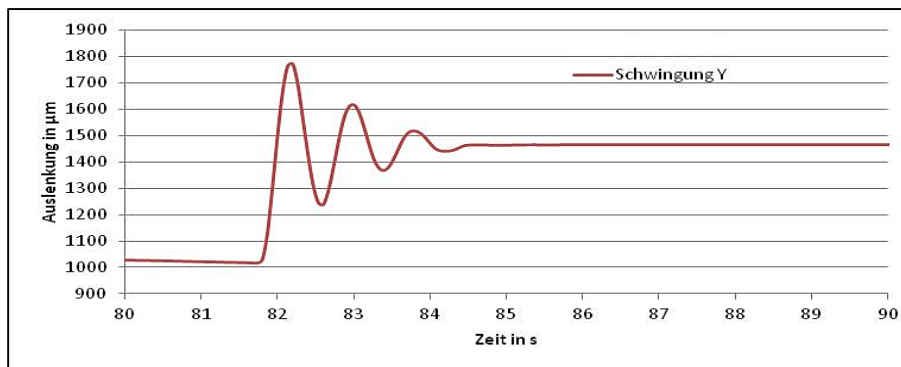
Abbildung 41: Dämpfung des Gehänges bzw. der Massescheiben [36]
