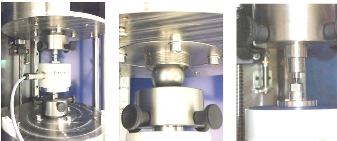
Abbildung 38: Methode der direkten, kugelgespannten Einspannung von Kraftsensoren und Verwendung von Stahlspitzen zur Kraftübertragung
