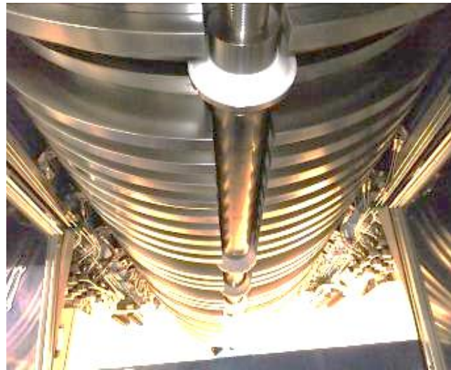
Abbildung 29: Haltekonstruktion der Gewichtsscheiben und Bestückung mit 5000 N Gewichtsscheiben in Verbindung mit dem Systemgehänge
