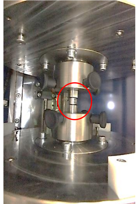
Abbildung 53: Direktmessung der Verformung der 2 kN-Totlastanlage ohne Transfornormal
