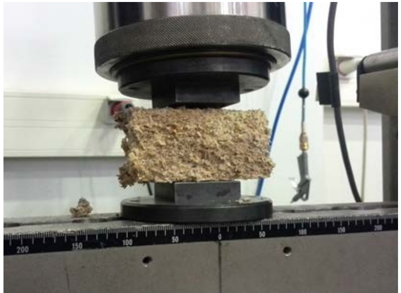
Abb. 137. Eine übrig gebliebene Hälfte des Pilzstreifens wurde letztendlich auf der Presse auf die Druckfestigkeit untersucht. Die Daten kann man der Grafik entnehmen.
