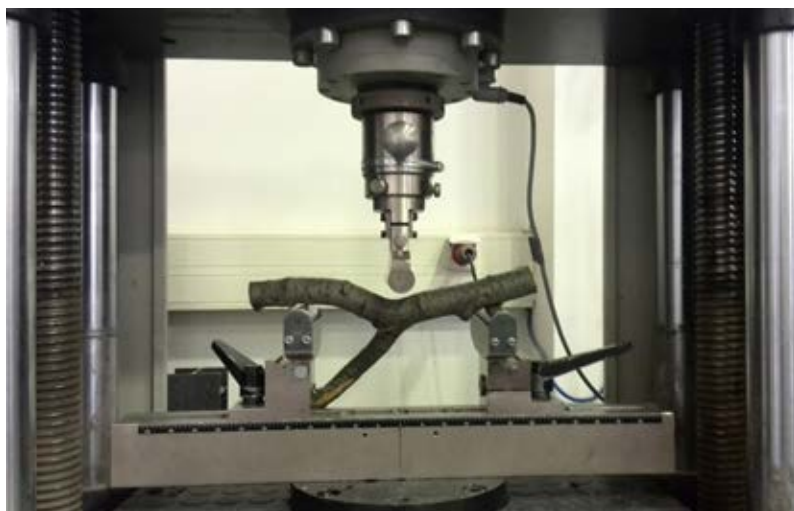
Abb. 119. Während des Tests, rutschte die Astgabel von den Auflagern ab, was man im Diagramm bei der roten Kurve beobachten kann. Bei einer Neuauflagerung und wiederholtem Versuch wurden letztendlich die Werte der grünen Kurve erreicht.
