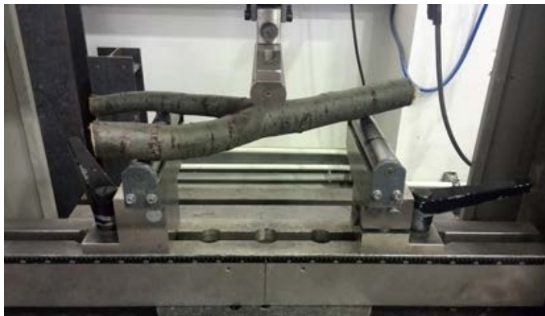
Abb. 118. Die Positionierung des Versuchskörpers an der Presse. Ziel war es, die Beanspruchung am Knoten zu testen.
