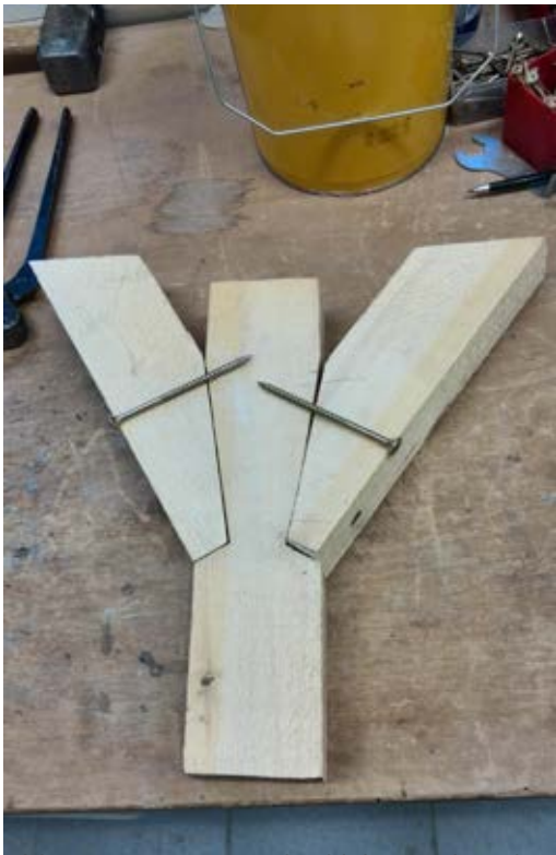
Abb. 113. Das Versuchsobjekt wurde mit 4 Schrauben verbunden, letztendlich auf der Presse geprüft. Ohne seitliche Latten versagt die Verbindung an den Schrauben, die Daten sind der Grafik zu entnehmen.
