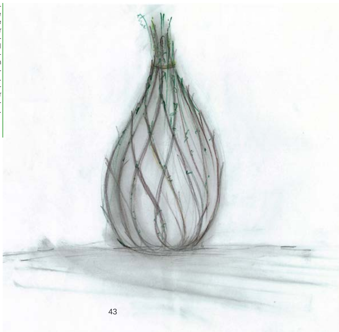
Abb. 69. Eine fertig zugebundene Struktur. Diese Form erlaubt der Pflanze sich problemlos weiter auszubreiten und zu atmen. Die Baumkrone und die Blattmasse würde kollektiv, für alle Pflanzen, im obigen Bereich ausgebildet sein. Diese kegelförmige Öffnung eignet sich auch für eine Lichtöffnung für unsere Innenräume.
