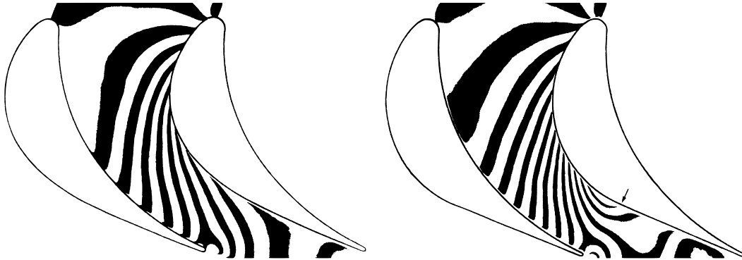
Abbildung 3.11.: Interferenzaufnahme bei stetig veränderlicher Krümmung (links) und bei Vorhandensein eines Krümmungssprunges auf der Saugseite (rechts) (CORDES [3])
