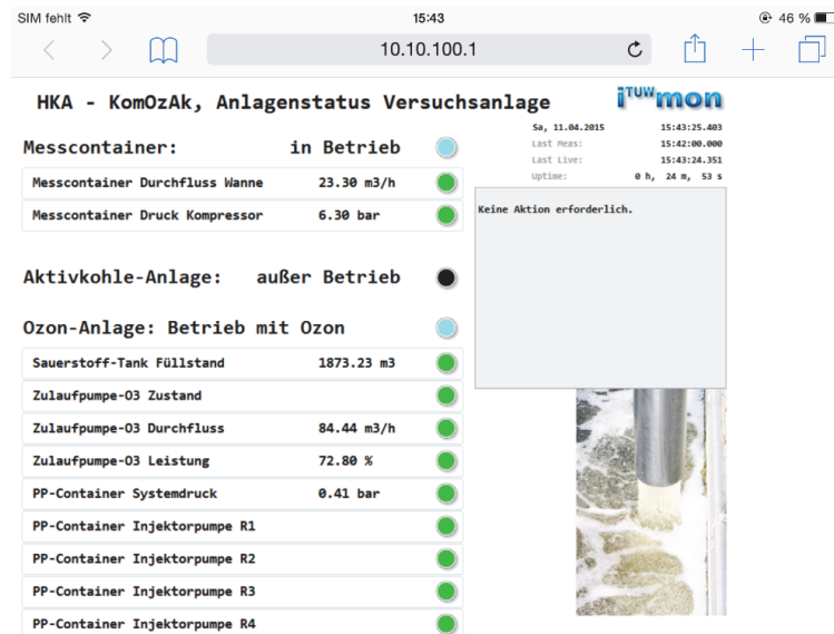
Abbildung 26: Darstellung des Stationszustandes in der Leitwarte [KHKS15]
