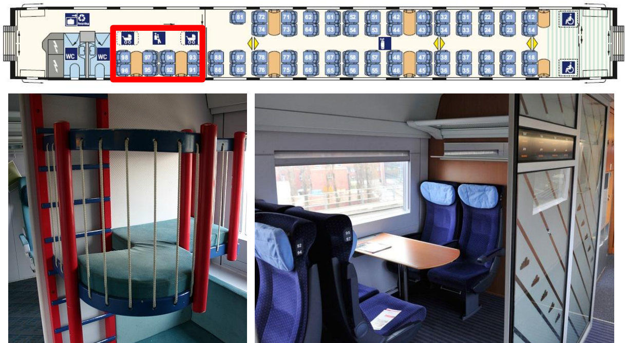
Abb. 7.18a-c ICE 2: Wagenplan nach Redesign (Familienabteil hervorgehoben, o.), Ansichten des Zugs (u. li. vor, u. re. nach dem Redesign) Quellen: a: DREHSCHLEIBE ONLINE (2012), b: FRANKE (2016d), c: DB/VOLKER EMESLEBEN (o.J.)
