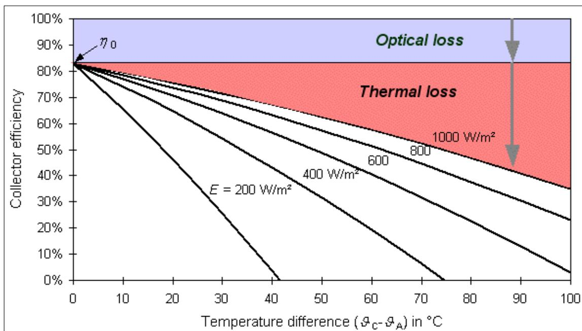
**Figure 27:** Collector efficiency curves. *Source:* Erneuerbare Energien und Klimaschutz, available from: <https://www.volker-quaschning.de/articles/fundamentals4/index.php>
