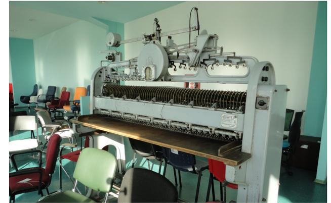
Abb. 4.-30. Lederflächen-Meßmaschine
