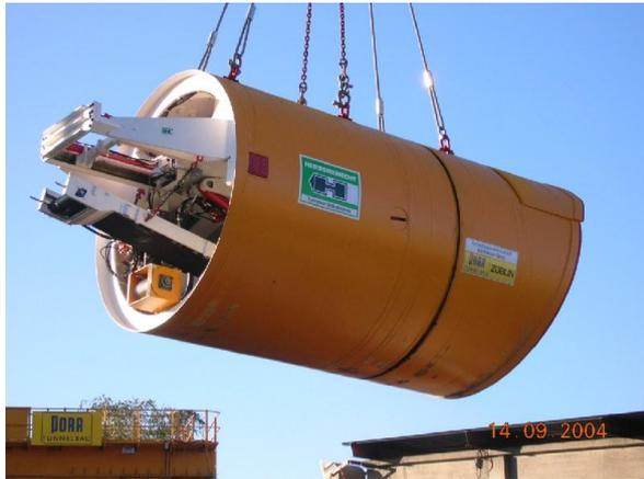
**Abb. 23: KK Graz, Vortriebsmaschine.**
