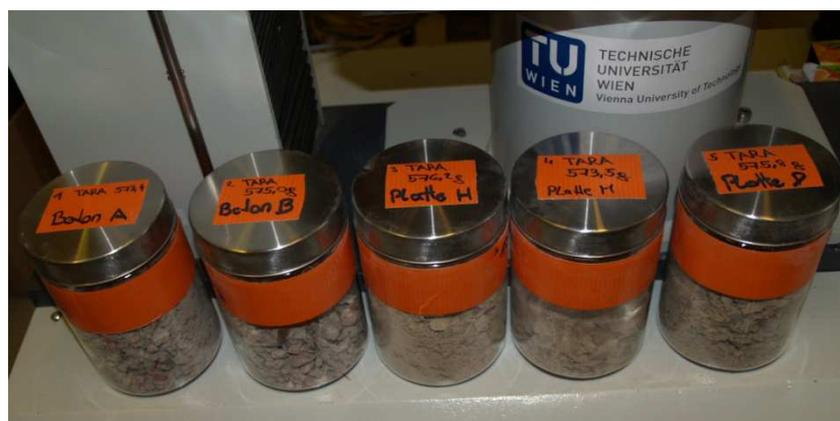
Abbildung 8.3: Zerkleinerten Festbeton- und Plattenprobe
