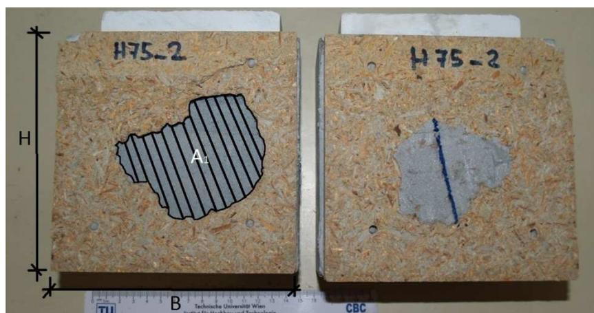
Abbildung 6.11: Vermessen der Bruchfläche – H75\_2 mit Abzugsfläche  $A_1$
