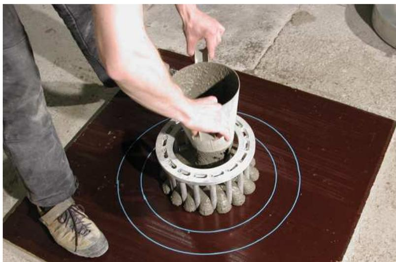
Abbildung 4.1: Überprüfung der Fließfähigkeit mit Blockierring [3]
