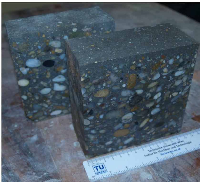
Abbildung 8.1: Betonproben A u. B der Vorversuche zur Zementgehaltsanalyse
