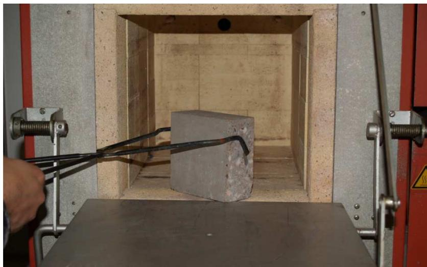
Abbildung 8.2: Betonprobe nach dem Glühen bei 450 °C
