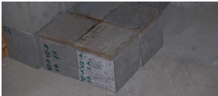
Abbildung 7.9: Lagerung der Proben während der Aushärtung
