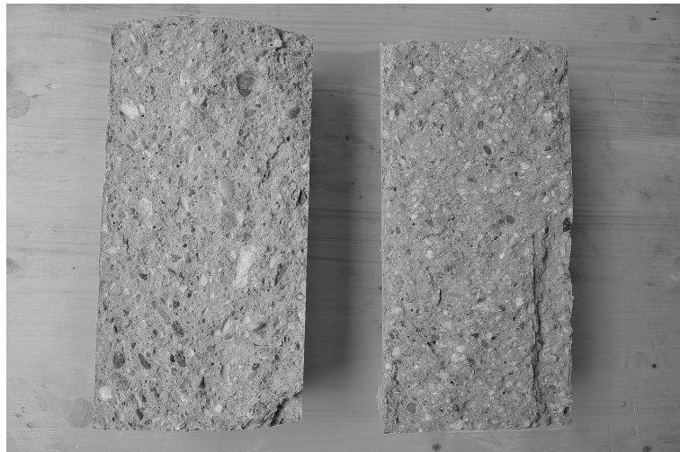
Abbildung 5.8: Rissfläche bei Spaltzugversuch
