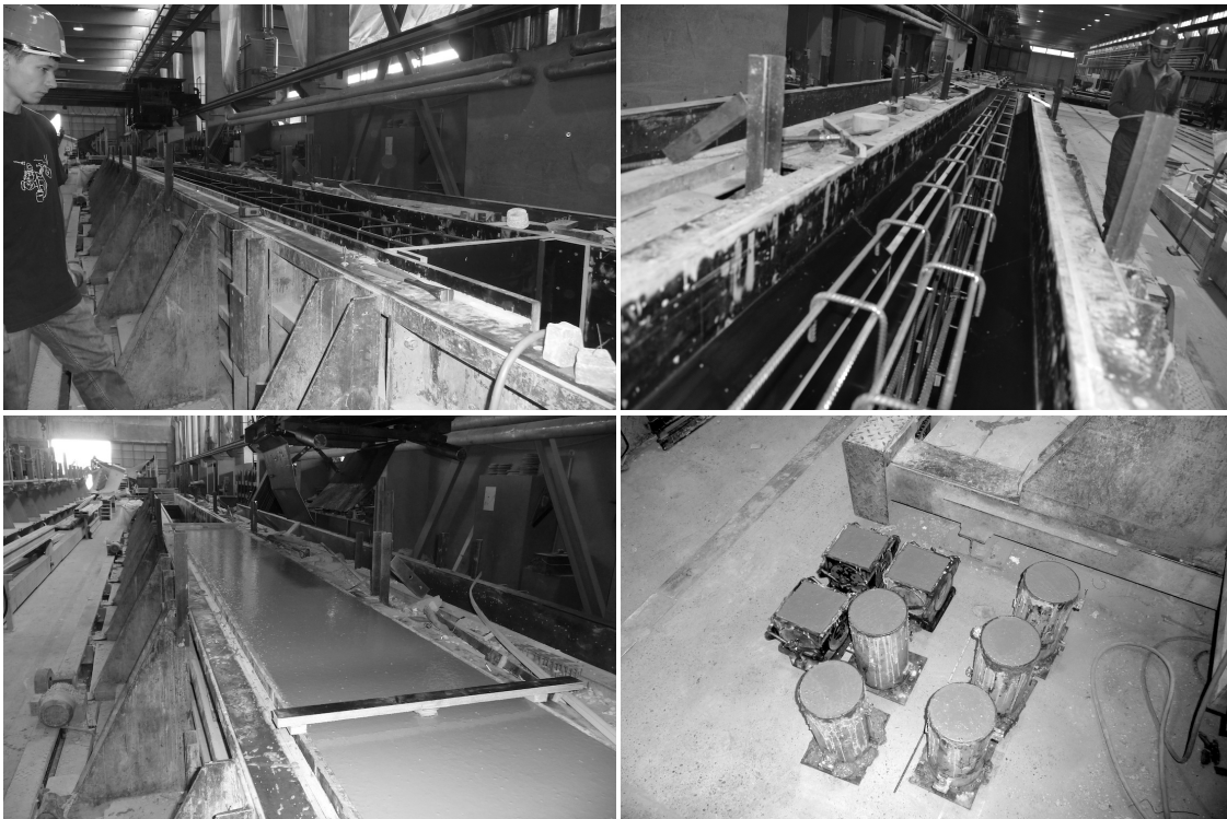
Abbildung 3.4: Herstellung der Versuchskörper bei Oberndorfer in Gars am Kamp
