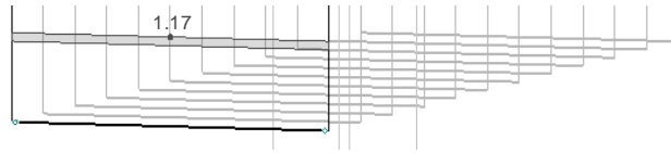
Abbildung 6.46: Verteilbalken [VTB] – FLS Vorspannung – Eigengewicht
