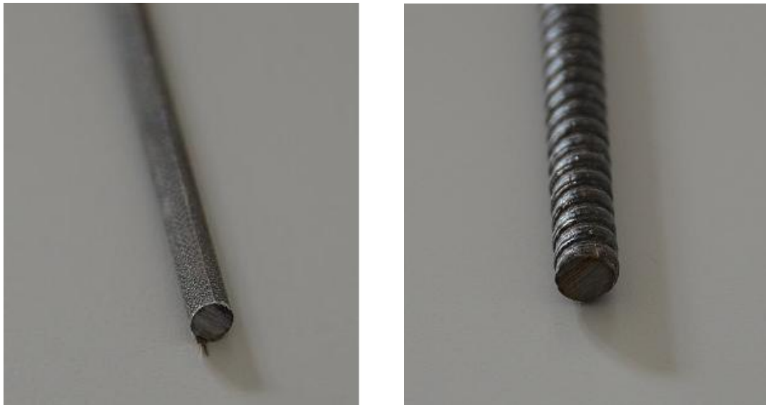
Abbildung 6.3: Basaltfaserstab links: 6mm glatt; rechts 8mm gerippt
