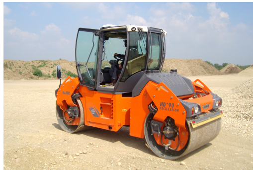
Abbildung 3.13: Walze HD+ 90 VO der Firma HAMM AG
