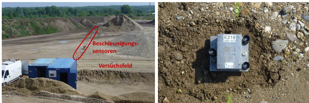
Abbildung 3.22: Messungen zur Erschütterungsausbreitung mit den entlang einer Linie aufgestellten Beschleunigungssensoren
