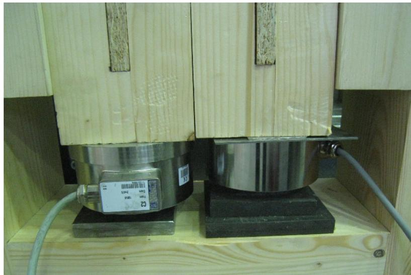
Abbildung 4-42: Kraftmessung obere/untere OSB Platte
