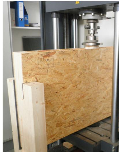
Abbildung 4-33: Versuchsdurchführung Mehrfachklammerung
