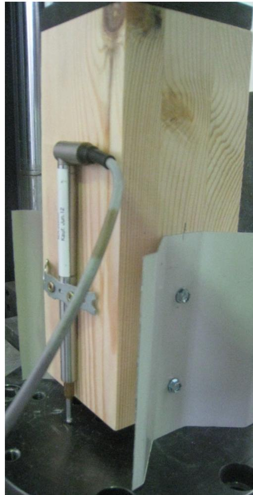
Abbildung 4-25: Prüfkörper mit Trapezblech und Bohrschraube
