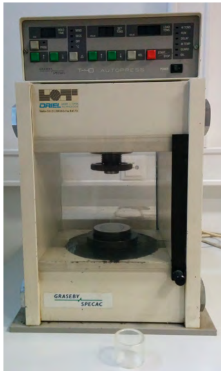
Abbildung 7.2.: hydraulische Presse der Firma Specac mit Kunststoffring
