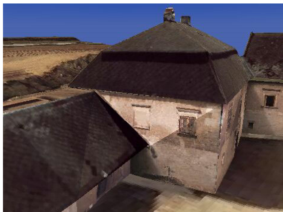
Abbildung 4-6: störender Helligkeitssprung in einer Fassade durch Verwendung unterschiedlicher radiometrisch nicht korrigierter Aufnahmen
