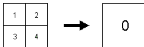
Abbildung 6-3: Prinzip der LOD Erzeugung
