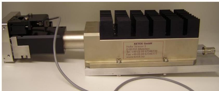
**Abb. 8.2:** Siliziumdriftdetektor von Ketek mit befestigtem He-Port
