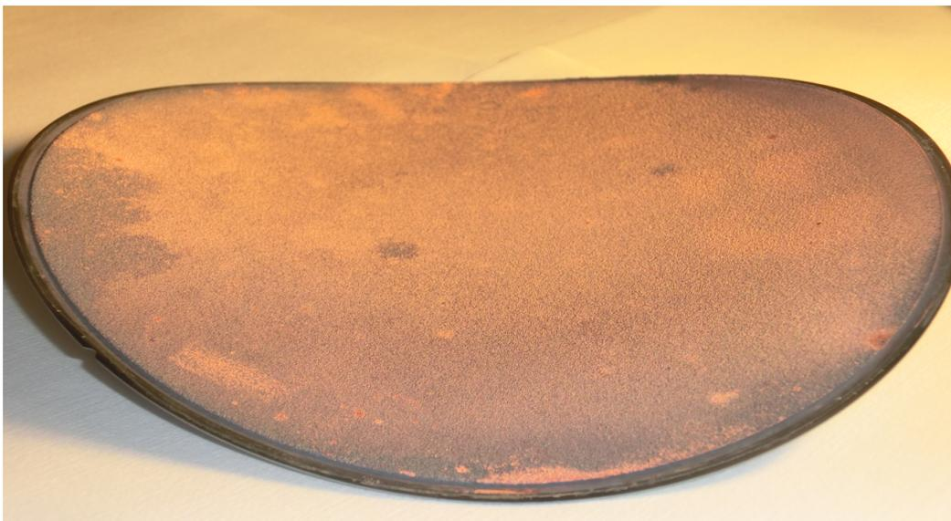
**Abbildung 87:** Wafer mit 4 Sedimentationsschichten  $CCu < 50 \mu m$  zu je 2 g und galvanischem Kupferäquivalent von  $500 \mu m$ . Nach Tempern bei  $400 \text{ }^\circ C$ .
