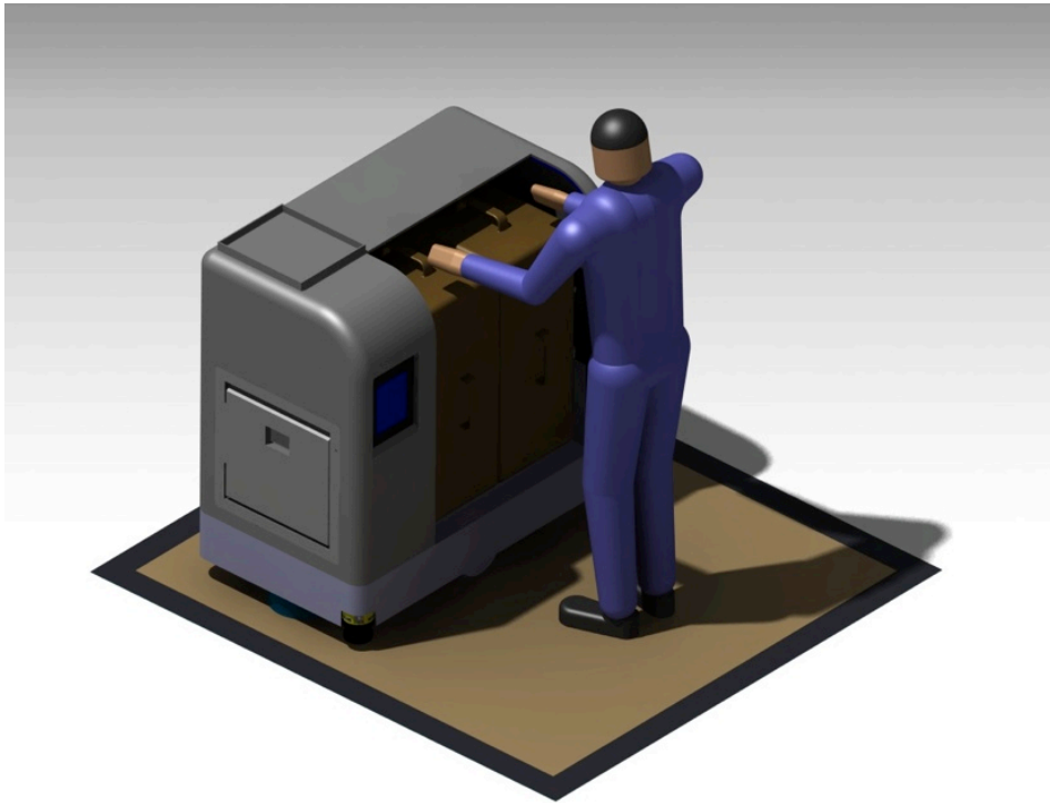
Abbildung 55: Lange Rolltor-Variante mit seitlichem Bedienelement
