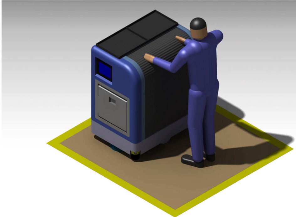
Abbildung 56: Kurze Rolltor Variante mit Bedienelement an der Hinterseite
