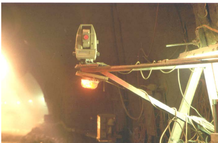
Abb. 7: Sensor und Steuereinheit zur automatischen Verschiebungsmessung
