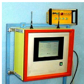
Abb. 7: Sensor und Steuereinheit zur automatischen Verschiebungsmessung
