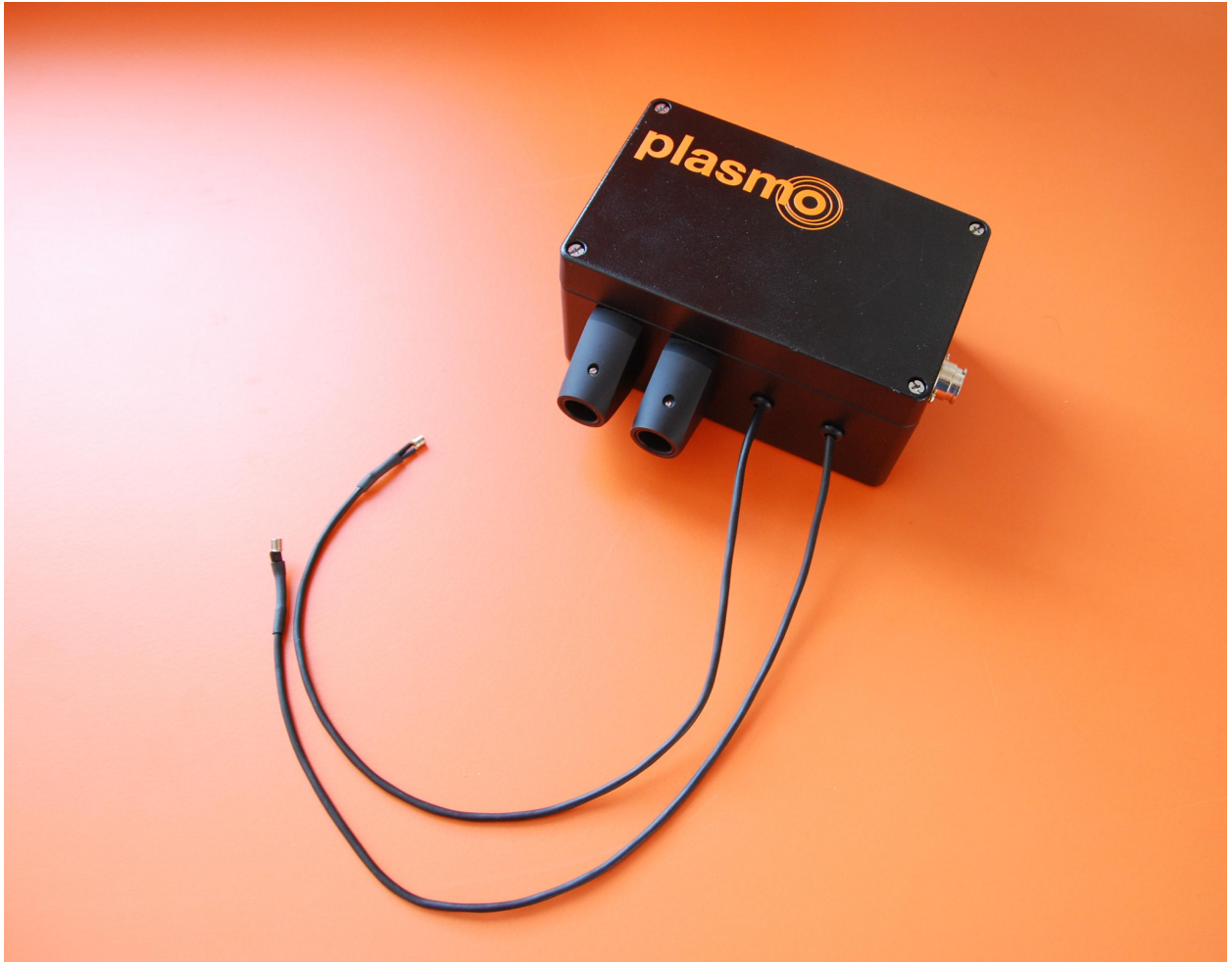
Abbildung 4.9: Foto des fertig aufgebauten Messverstärkers
