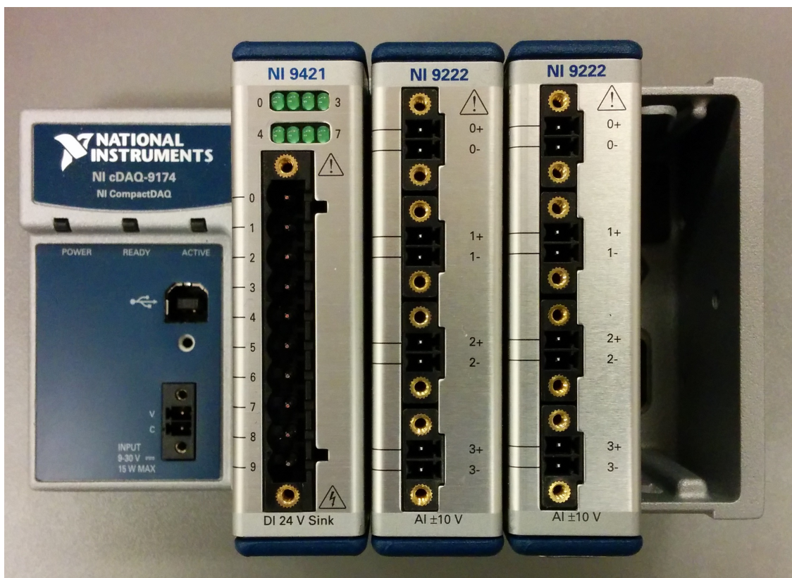
Abbildung 5.2: Foto des cDAQ-Systems von National Instruments
