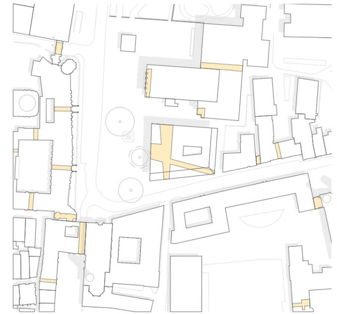
Analysiert man die Umgebung des Bauplatzes fällt auf, dass dessen Erschließung, abseits der Strassen, von zahllosen Durchgängen geprägt ist. Der Baukörper nimmt dieses Prinzip der Durchquerung und Abkürzung auf. Diagonal zwischen dem Hauptplatz und der Universitätsstrasse - quer als Verbindung zwischen der Tiefgarage und der Stichstrasse im Süden in Richtung Zentrum.
