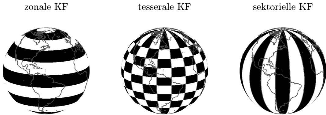
Abbildung 10: Arten von Kugelflächenfunktionen. Zum besseren Verständnis wird nur das Signum der Funktion dargestellt. Links: sektorielle Kugelflächenfunktion n = 10 , m = 0 . Mitte: tesserale Kugelflächenfunktion n = 17 , m = 8 . Rechts: sektorielle Kugelflächenfunktion n = 9 , m = 9
