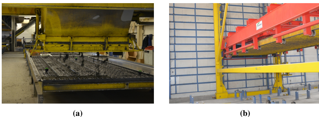
Abbildung 3.7: Herstellung von Doppelwänden: (a) Betoniervorgang; (b) Trocknungsanlage.
