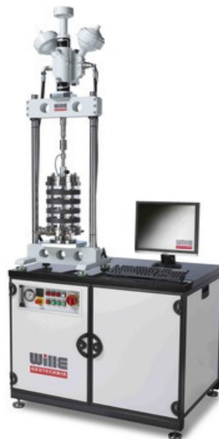
Abbildung 5: Vollautomatisches Triaxialgerät der Fa. WILLE
