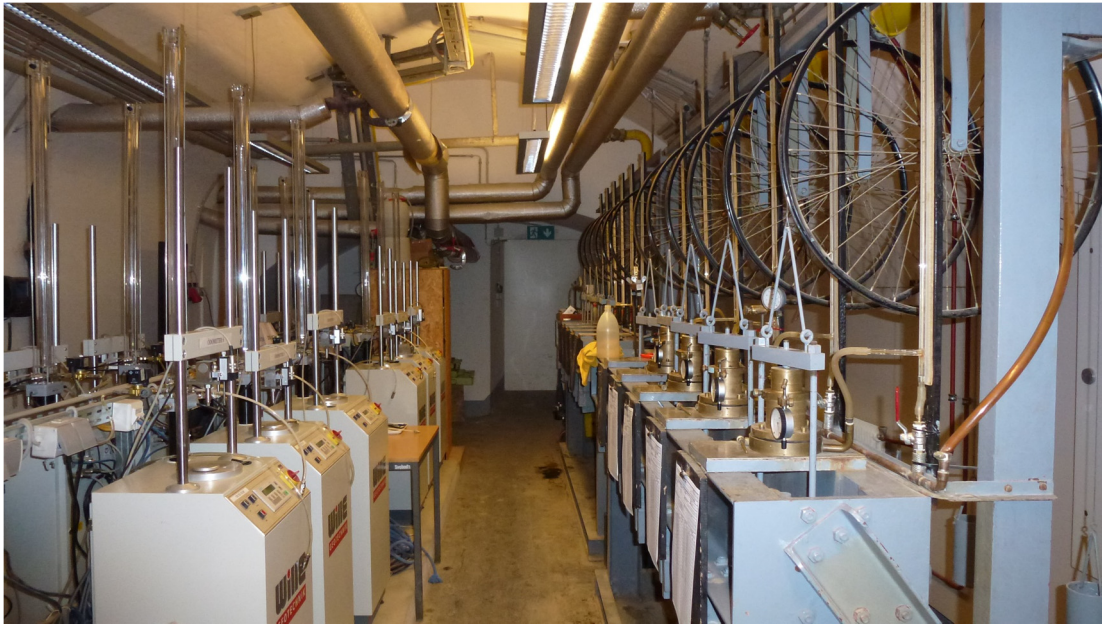
Abbildung 3: Links: vollautomatische Kompressionsgeräte; Rechts: Ödometer nach Terzaghi im Erdbaulaboratorim der TU Wien
