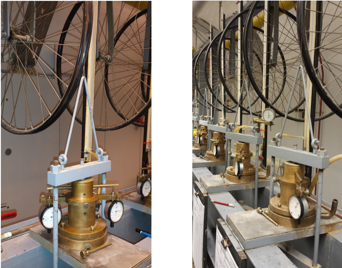
Abbildung 27: Prüfstand mit Ödometern nach Terzaghi (1925) im Erdbaulaboratorium TU Wien
