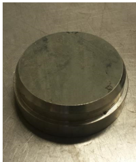
Abbildung 31: Einbau der Bodenprobe in den Probenring
