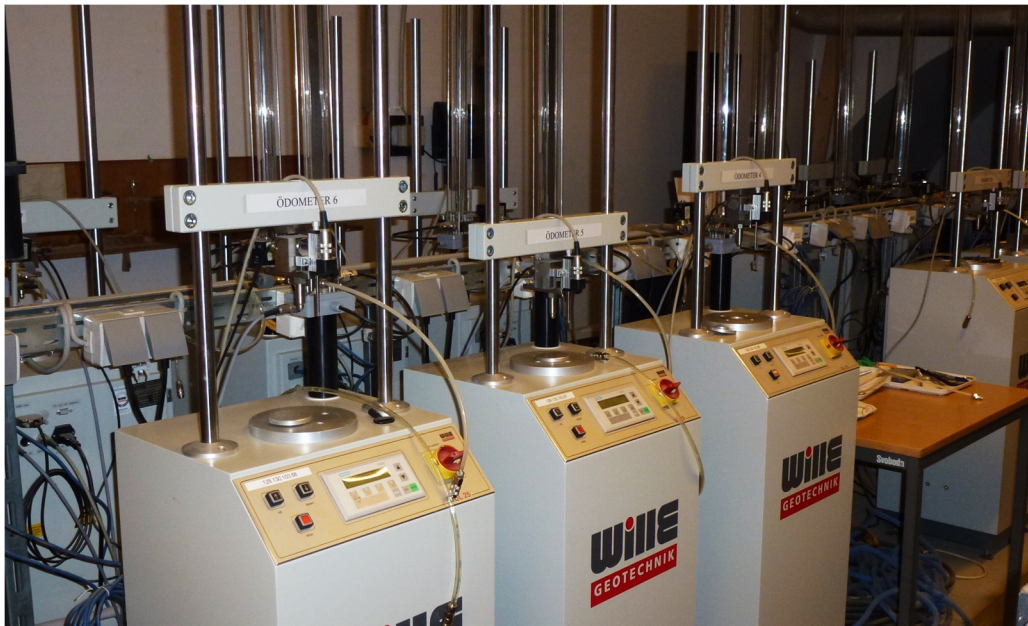
Abbildung 29: Kompressionsgerätstand mit elektronisch gesteuerter Lastaufbringung im Erdbaulaboratorium der TU Wien
