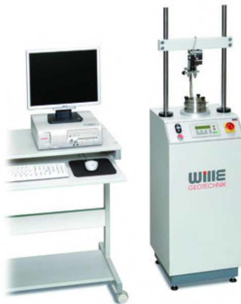
Abbildung 4: Kompressionsgerät mit elektronisch gesteuerter Lastaufbringung und automatischer Messwerterfassung der Fa. WILLE
