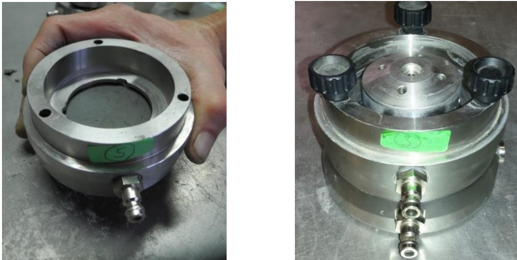
Abbildung 32: Edelstahl- Ödometer mit eingebautem Ausstechring
