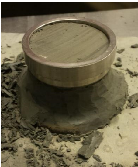
Abbildung 31: Einbau der Bodenprobe in den Probenring
