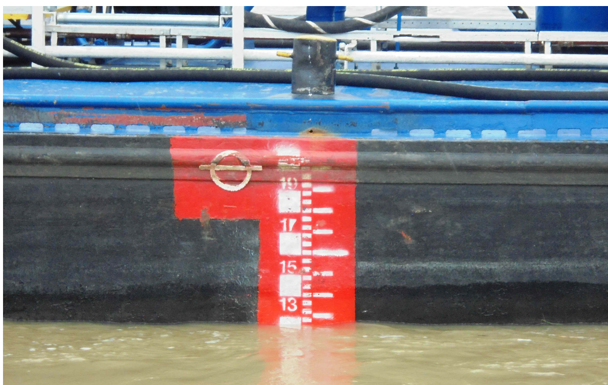
Abbildung 6.2: Ahming und Freibordmarke auf der M/S „Wientank-1“ 221
