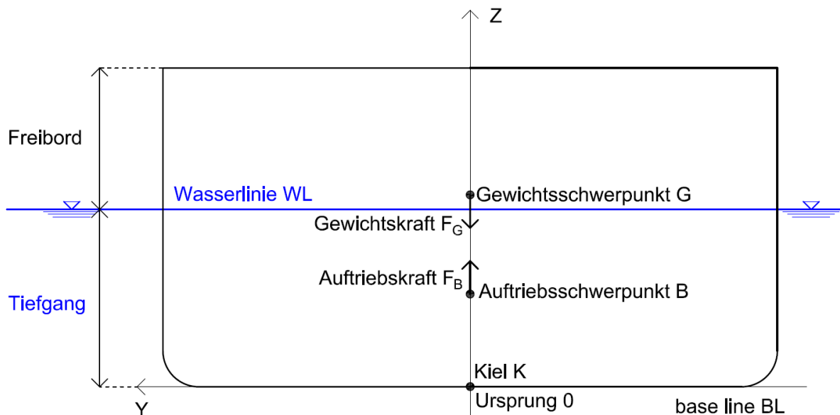
Abbildung 3.2: Schiffsquerschnitt, Gewichtsschwerpunkt / Auftriebsschwerpunkt 22
