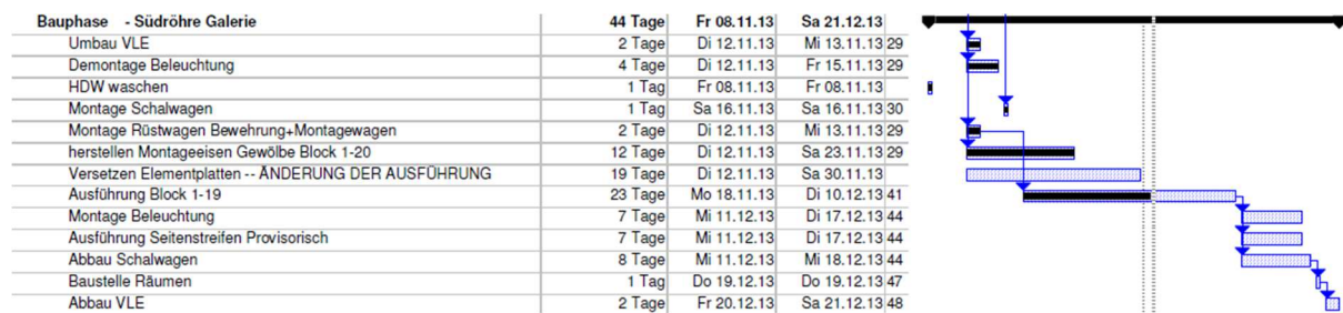
Abbildung 4.6: Bauzeitplan für das Einziehen der neuen Innenschale in der Südröhre (exkl. Vorarbeiten) 116
