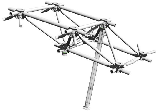
Glasstütze an Knoten der Obergurte
