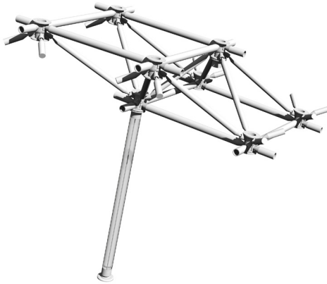
Glasstütze an Knoten der Untergurte
