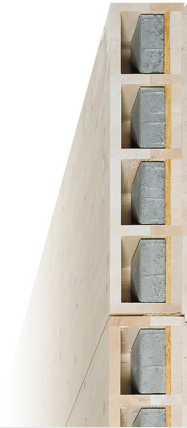
Flächenelemente mit integrierten Gewichten
