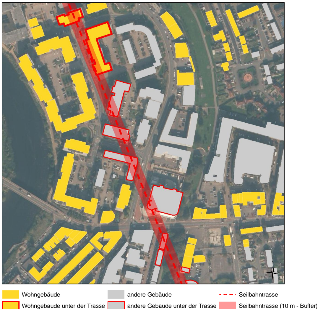
Abbildung 7-19: Ermittlung der Wohngebäude und Gebäude mit anderer Nutzung unter der Seilbahntrasse (Ausschnitt, maßstabslos); eigene Darstellung unter Verwendung von OpenStreetMap- und DigitalGlobe-Daten
