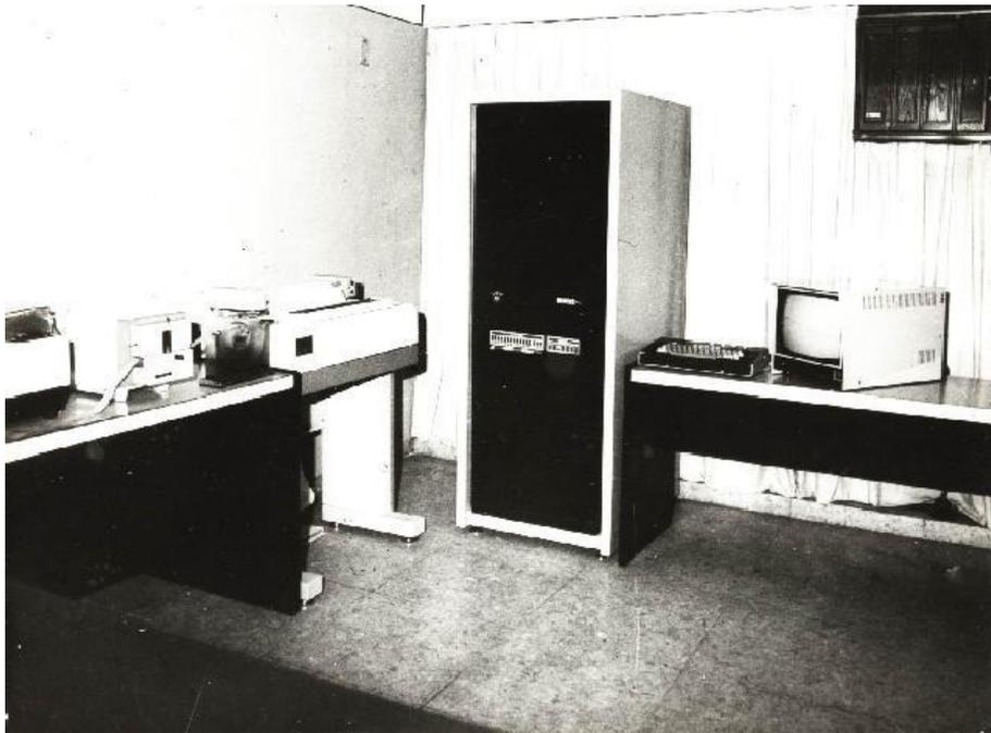
**Abbildung 2.1:** Kubanisches Minicomputer-System CID-300/10, Quelle: [17].
