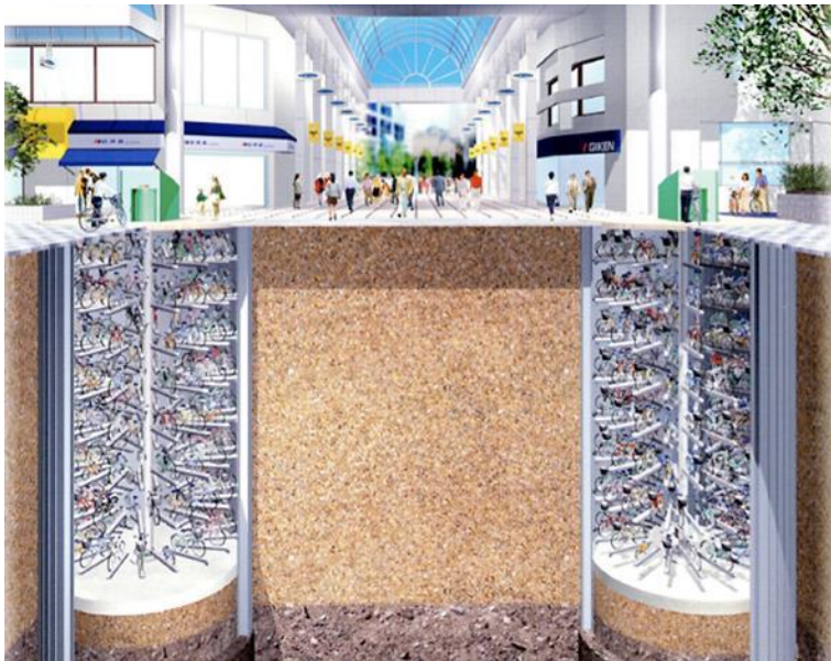
Abbildung 4.6.1-4: Parkieranlagen – Radtiefgarage (unterirdisch) - Tokyo 88
