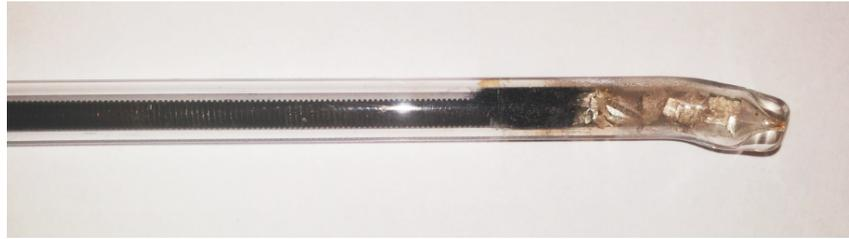
**Abbildung (4.4.1):** Beladenes Probenrohr mit Graphitfilz und Gewindestange
