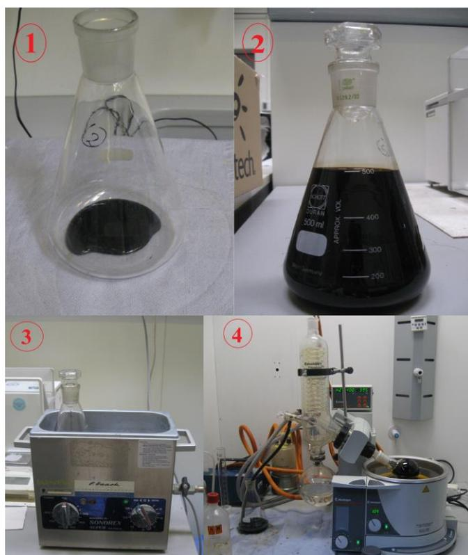
**Abbildung 21: gefüllte Kolben mit dem Bitumen (1); gefüllte Kolben mit dem Bitumen und mit Lösungsmittel (2); Ultraschallbad (3); Destillation durch Rotationsverdampfer (4)**
