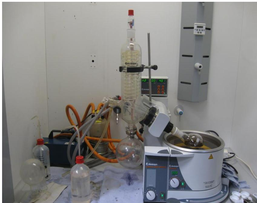
**Abbildung 11: verwendeter Rotationsverdampfer**
