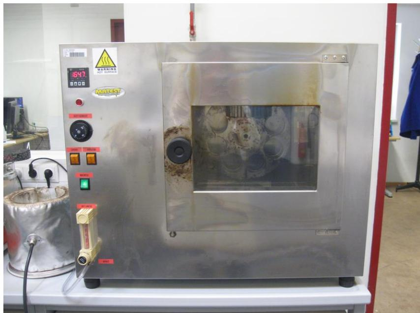
**Abbildung 19: RTFOT – Gerät**
