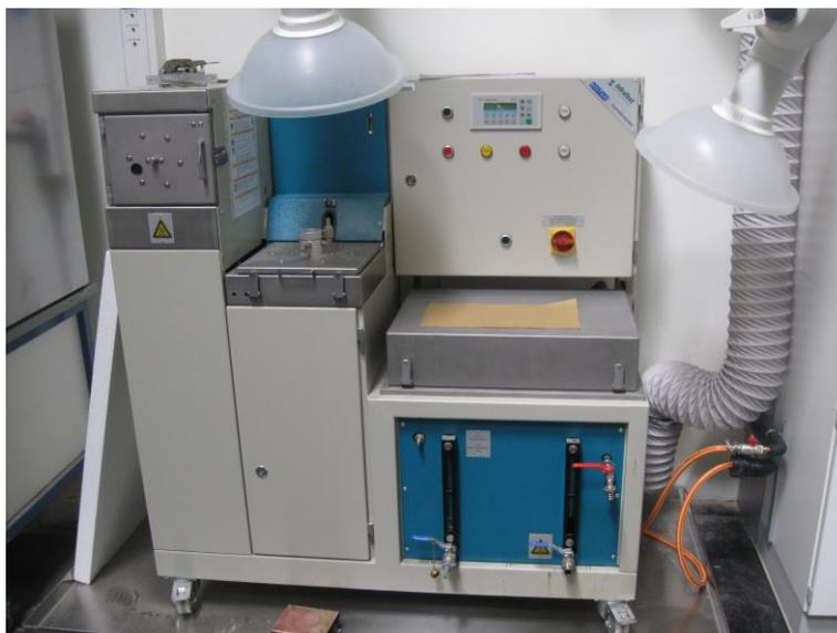
Abbildung 8: Asphaltanalysator (Extraktor)
