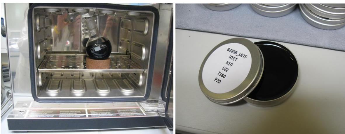
**Abbildung 22: Trockenschrank mit destillierter Bitumenprobe (links); fertige Probe für DSR-Versuch (rechts)**
