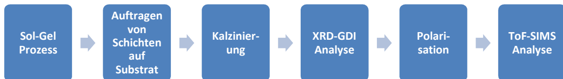
Abb. 3.9: Übersicht der Herstellung und Analyse der PZT-Schicht. Die mit organischer Synthese hergestellte PZT-Präkursorlösung wurde auf ein Substrat aufgetragen, danach kalziniert. Die Kristallstruktur wurde mittels Röntgendiffraktometrie bestimmt.
