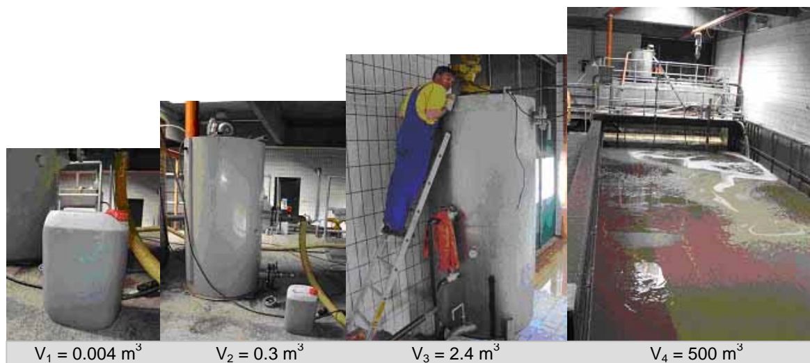
Abbildung 8: Stufenweise Reaktorvergrößerung um jeweils 1 bis 2 Größenordnungen zur Anreicherung der Biomasse für die Deammonifikation
