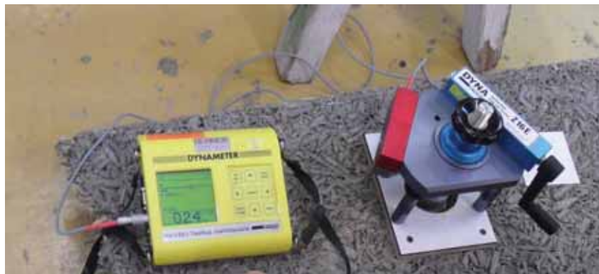
Abbildung 2.12.: Prüfeinheit Dynameter Z16E: Ausgabeinheit und Messeinheit, [17]
