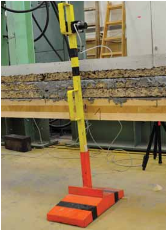
Abbildung 2.38.: Wegaufnehmer für vertikale Verschiebung mit Standbein und Stange
