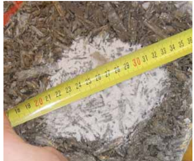
Abbildung 2.10.: Ermittlung des mittleren Durchmessers, D = 11 cm
