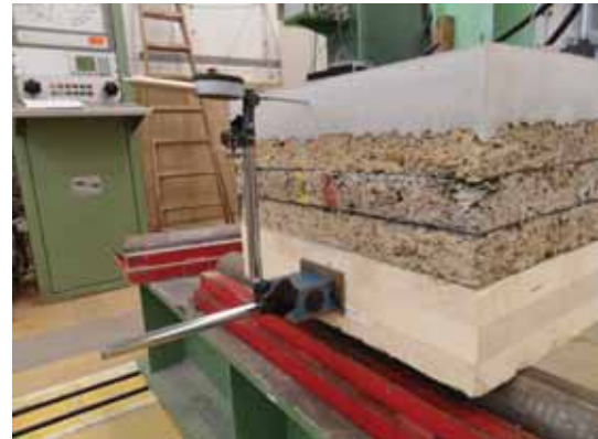
Abbildung 2.37.: Messuhr für horizontale Verschiebung am Bauteilende
