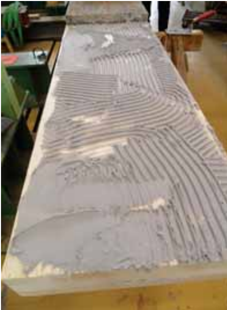
Abbildung 2.29.: Kleberauftrag auf die BSP- Platte
