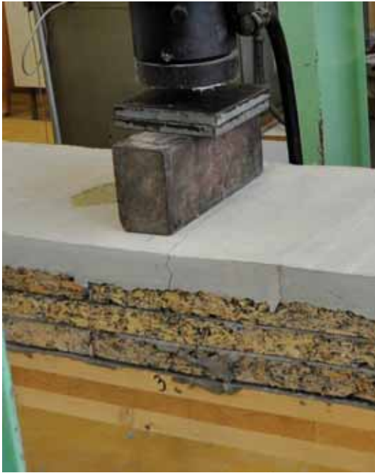
Abbildung 2.62.: Darstellung des Risses im Beton und Holzleichtbeton, nach F_{max} = 58 \text{ kN}
