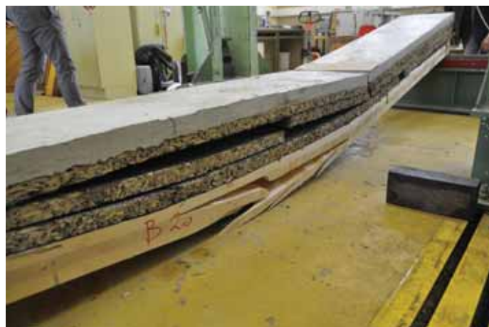
Abbildung 2.57.: Vollständiger Bruch des Bauteils in Trägermitte nach Wiederbelastung
