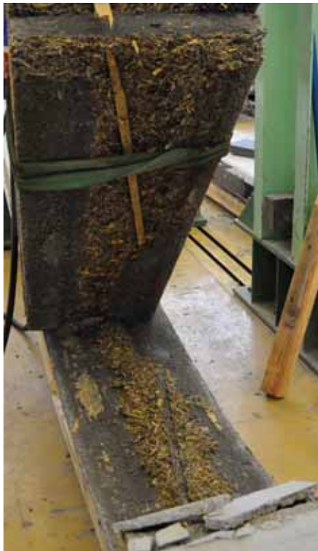
Abbildung 2.65.: Klebefuge zwischen BSP-Platte und Velox-Platte
