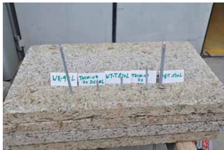
Abbildung 2.7.: Schraubenspitzen nach dem Durchbohren der vier Velox-Platten
