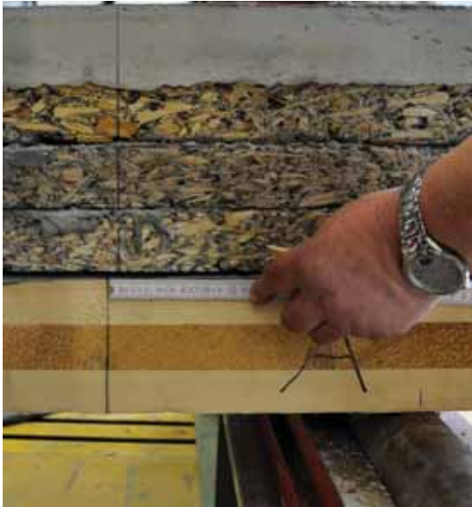
Abbildung 2.72.: Horizontale Verschiebung beim Auflager A, nach Entlastung auf 2,7 kN
