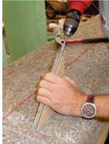
Abbildung 2.30.: Einschrauben der Schrauben
