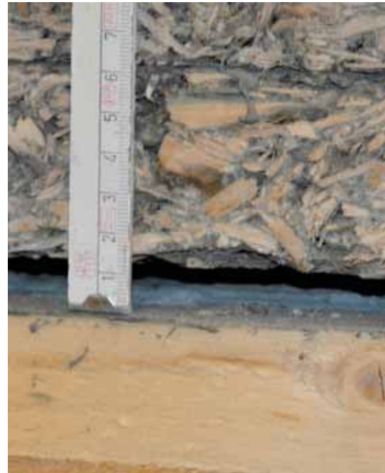
Abbildung 2.63.: Spalt zwischen BSP und Holzleichtbeton, nach F_{max} = 58 \text{ kN}
