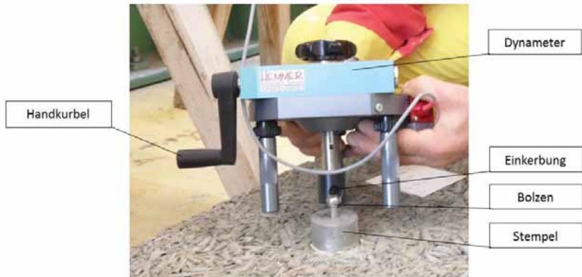
Abbildung 2.14.: Dynamometer Z16E: Hauptbestandteile der Messeinheit
