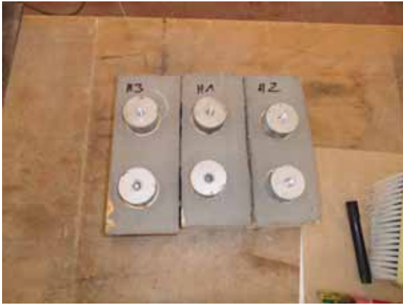
Abbildung 2.19.: Holzproben: SikaTop®-107 Seal auf Holz
