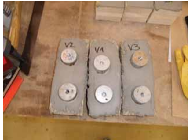
Abbildung 2.20.: Veloxproben: SikaTop®-107 Seal auf Velox
