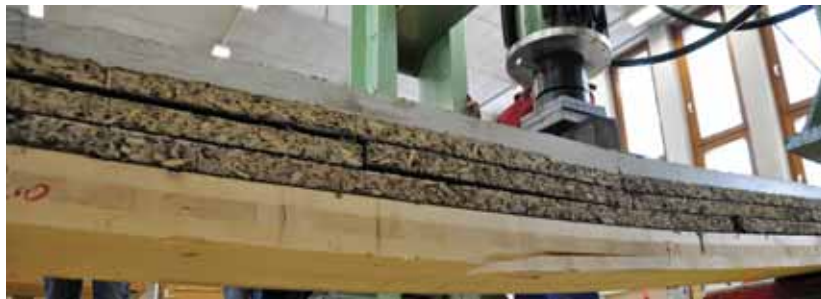
Abbildung 2.56.: Versagensdarstellung in Trägermitte nach F_{max} = 31 kN
