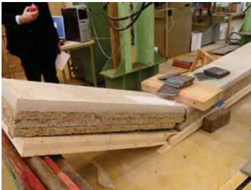
Abbildung 2.45.: Bruch nach Wiederbelastung bei F_A
