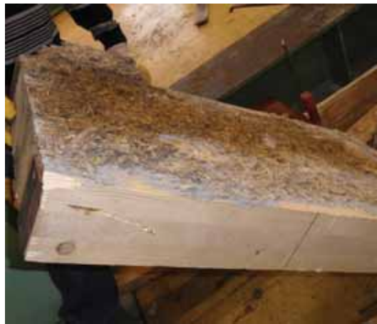
Abbildung 2.86.: SV1: Bruchbild des Scherversuch zw. BSP- und Veloxschicht
