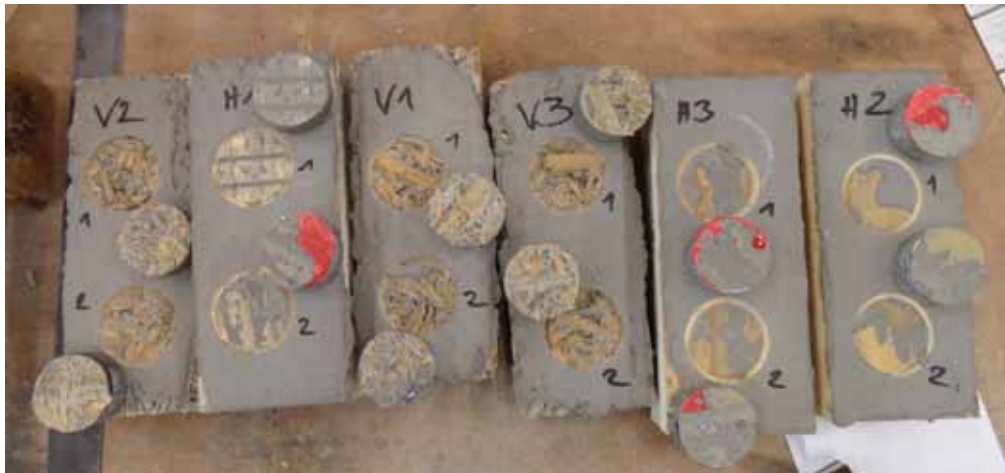
Abbildung 2.21.: Bruchflächen der Proben (SikaTop®-107 Seal); rote Markierung: fehlender Haftverbund zwischen Prüfkleber und Kleberoberfläche
