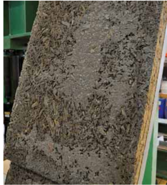
Abbildung 2.54.: Oberfläche der obersten Velox-Platte
