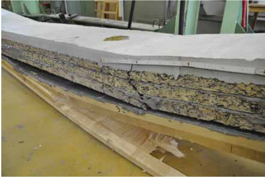
Abbildung 2.64.: Bruch nach Wiederbelastung bei Lasteinleitung F_B
