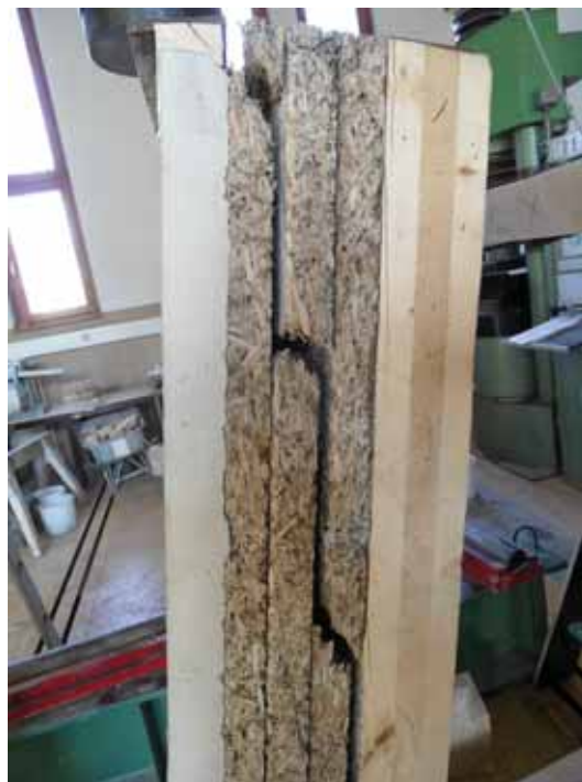
Abbildung 2.88.: SV2: seitliches Versagensdarstellung nach Bruch
