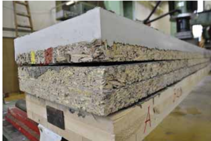
Abbildung 2.55.: Horizontale Verschiebung beim Auflager A, nach Maximalbelastung
