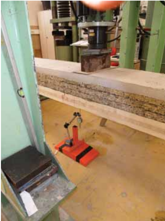
Abbildung 2.36.: Messuhr für vertikale Verschiebung, befestigt am Standbein
