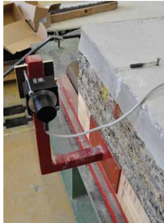
Abbildung 2.39.: Wegaufnehmer für horizontale Verschiebung am Bauteilende
