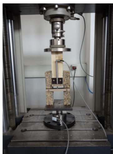
Abbildung 2-5: Kleinprobe zur Überprüfung des Klebesystems [6, S. 24]
