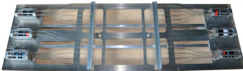
**Abbildung 2.9:** Ein Detektor von PERKEO III, bestehend aus einem Gestell auf dem der Szintillator, die Lichtleiter sowie die sechs Photomultiplier montiert sind.
